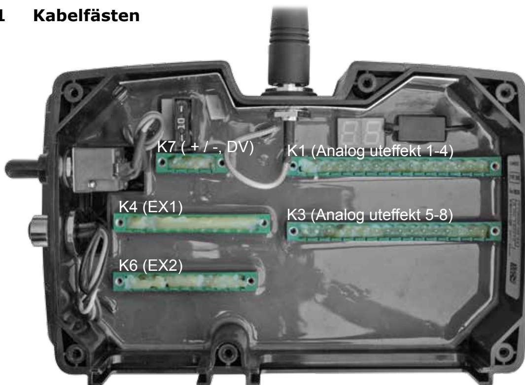
Figur 3.9. Figuren illustrerar insidan av kontaktdonet för elektronikboxen av standardtyp 2000 (Danfoss) och typ 3000 (pulsbreddmodulering, PWM).
