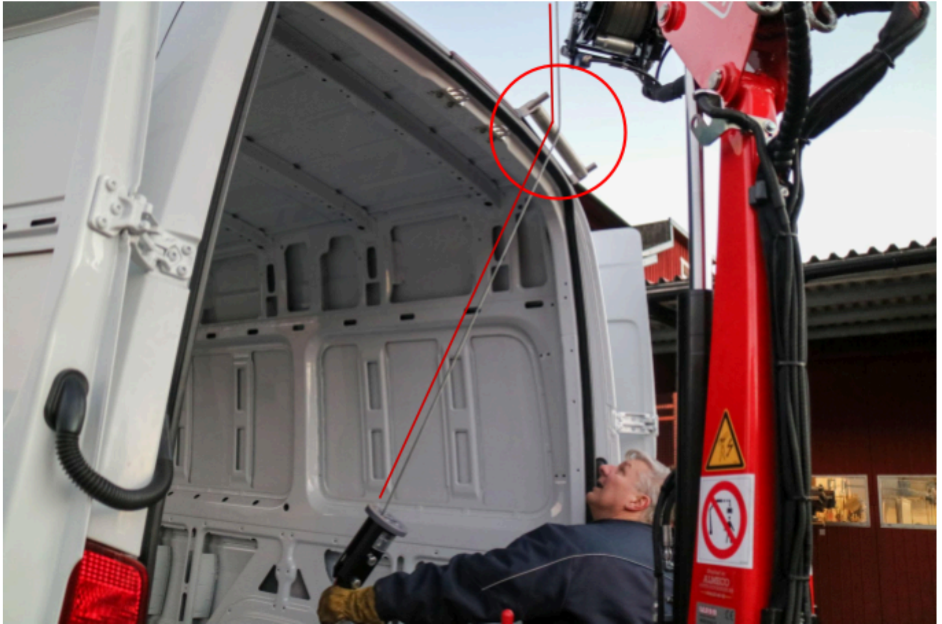
Figur 6. Skyddsrolle för vajer vid inkörning av kran.
