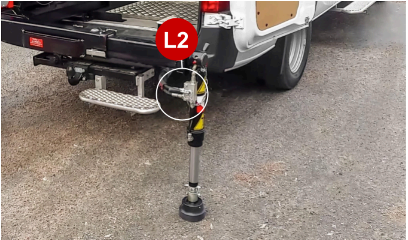
Figur 18. Avstängningsventil L2 ventilspak hydraulflöde stödben.
