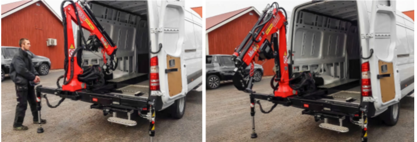
Figur 21. Kranens utsvängning till arbetsposition.
